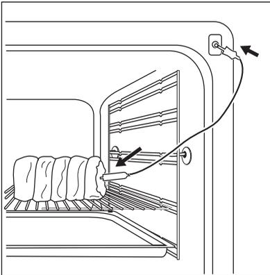
2. Tilslut stikket til termometeret i bøsningen på apparatets forside. Termometersymbolet
