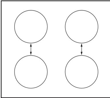
Effektstyringen fordeler effekten parvis mellem to kogezone (se tegningen). Boosterfunktionen øger effekten til det højeste trin for den ene kogezone i et par og sætter den anden kogezone ned på et lavere varmetrin. Displayet for den reducerede zone skifter mellem to niveauer.
